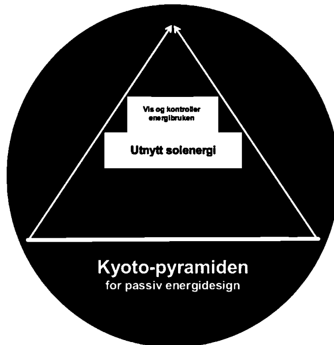
Figur 20 - Kyoto pyramiden, illustrasjon av anbefalt prioriteringsrekkefølge av ENØK tiltak
